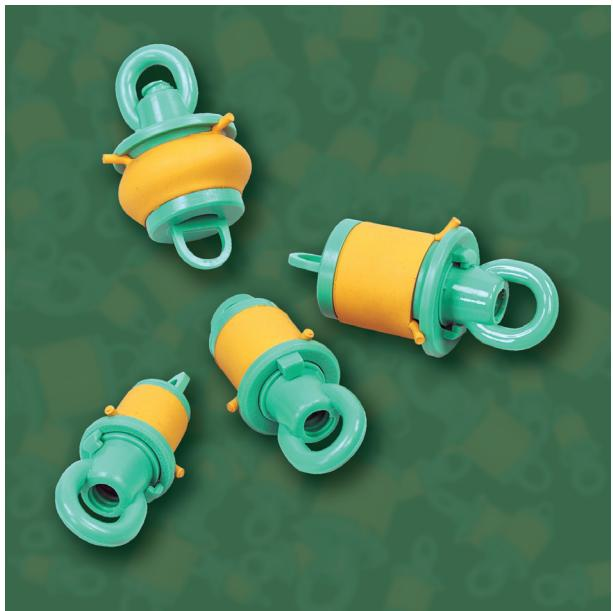
Герметизация неиспользуемых кабельных каналов до прокладки кабелей предотвращает попадание в них грязи, что снижает трение между поверхностью канала и оболочкой кабеля, облегчая процесс прокладки кабеля. В итоге - снижение расходов.
