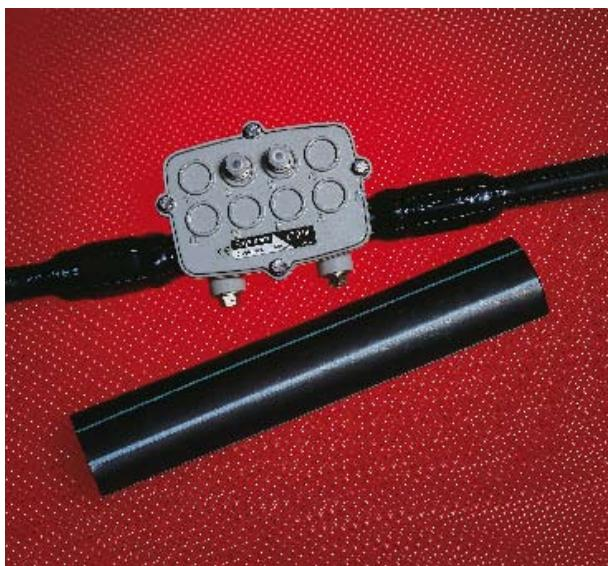
Трубка TCS2 фирмы Tyco Electronics - перекрестно связанные радиацией термоусаживаемая полиолефиновая трубка - применяется для изолирования и герметизации соединений подземных и подвесных кабелей на сетях кабельного телевидения. Такие кабельные соединения включают сростки, магистральные усилители, удлинители линии, разветвители, подземные блоки и ответвители. TCS может также использоваться в электрических распределительных сетях с напряжением до 600 В.
