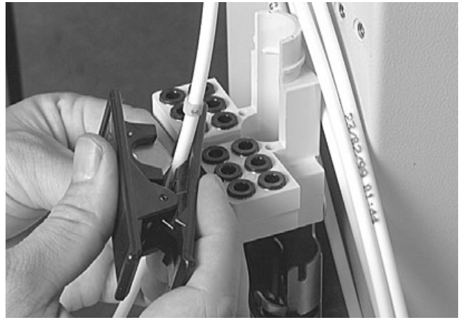
4.2.11 Отрежьте трубки на одну длину, используя резак для трубок. Убедитесь, что панель открыта.
