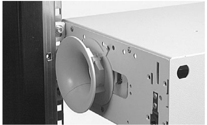
3.7 Установите раструб прямо перед боковым отверстием панели, совместите маленькие замки с пазами, вставьте и поверните раструб пока фиксаторы не попадут в фиксирующие выемки.
