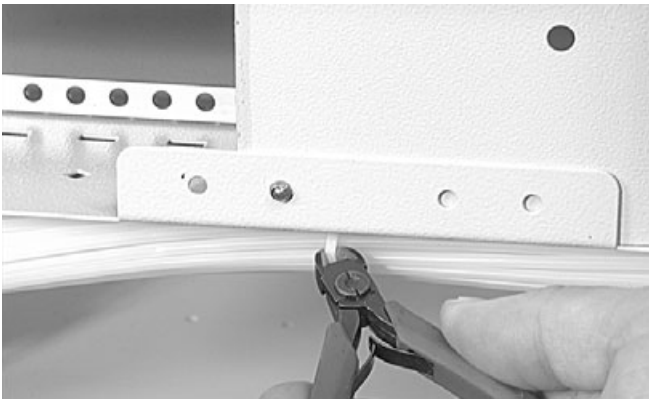
4.1.14 Всегда удаляйте два пояска снизу панели.
