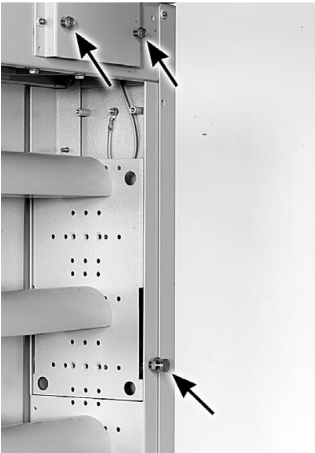
3.3.2 Ослабьте все болты на боковом канале примерно на 5 мм (никогда не выкручивайте их полностью).
