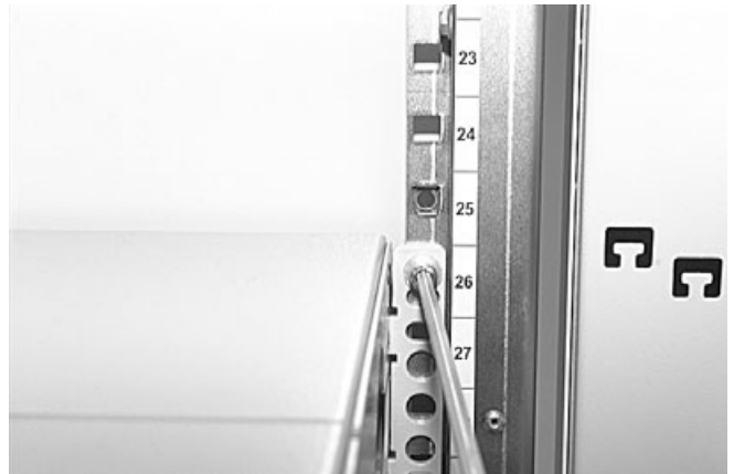
7.5.1 Расположите гайки в вертикальных направляющих стойки на места установки панелей; рассчитайте места установки гаек исходя из расчёта - 5 юнитов для панели или РОМ, 7 юнитов для НРМ.
