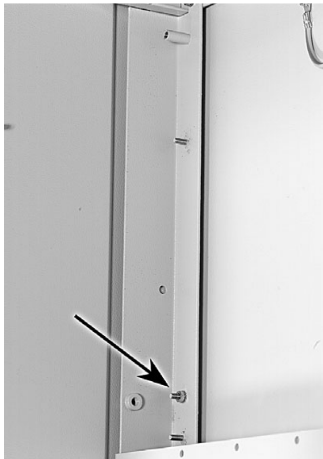
7.1.6 Если кабель вводится позади платы с катушками (см. 7.1.5): не ставьте сверху распорку, а в ее качестве используйте снизу 1 гайку M4 (1).
