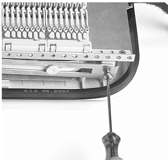
3.4.3 Закрепите корзину в скользящем механизме металлического профиля кассеты и зафиксируйте профиль с помощью винта.
