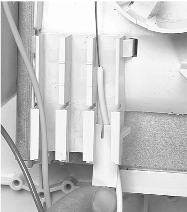
6.3.3.4 Расположите модули в держателе. Установите крышку-зажим над модулями в прорезь на держателе. Закрепите модули, продольно перемещая крышку-зажим до упора.
