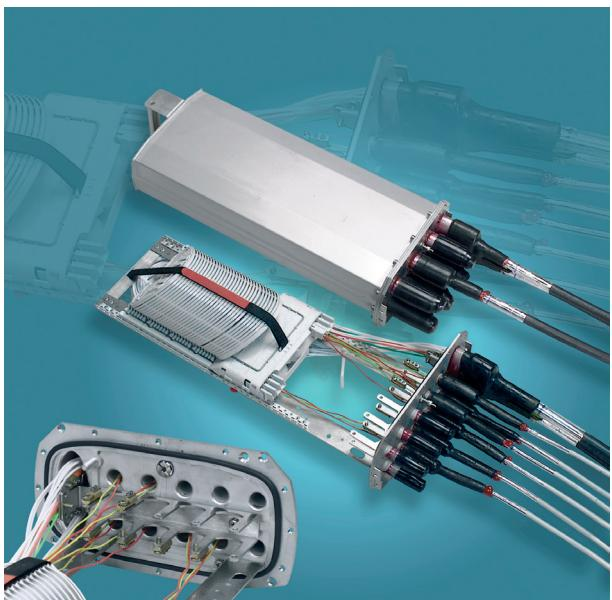
Муфта FIST-SCO2 для установки в городской канализации - это герметичная и защищенная от воздействия окружающей среды система организации оптоволокна, которая обеспечивает функционирование сростков и пассивных компонентов оптических сетей. Плоская металлическая муфта специально разработана для установки в системах городской канализации и характеризуется повышенной стойкостью к очень агрессивной окружающей среде.
