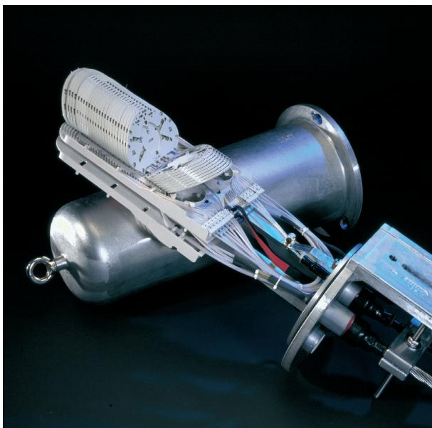
Муфта FIST-MCO - это тупиковая металлическая муфта, специально разработанная для монтажа волоконно-оптических кабелей, подвешиваемых на опорах линий электропередачи.
