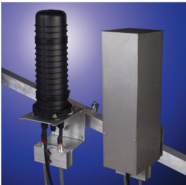
Муфта FOSC-OPGW - это тупиковая металлическая муфта, специально разработана для монтажа оптоволоконных кабелей, вмонтированных внутри грозозащитного тросса для воздушных линий электропередачи. Муфта разработана для наружного применения; она может быть закреплена на высоковольтных опорах, столбах, стенах или других конструкциях. Муфта может использоваться для герметизации ответвительных и разветвительных сростков, внешних узлов, распределительных участков сети.
