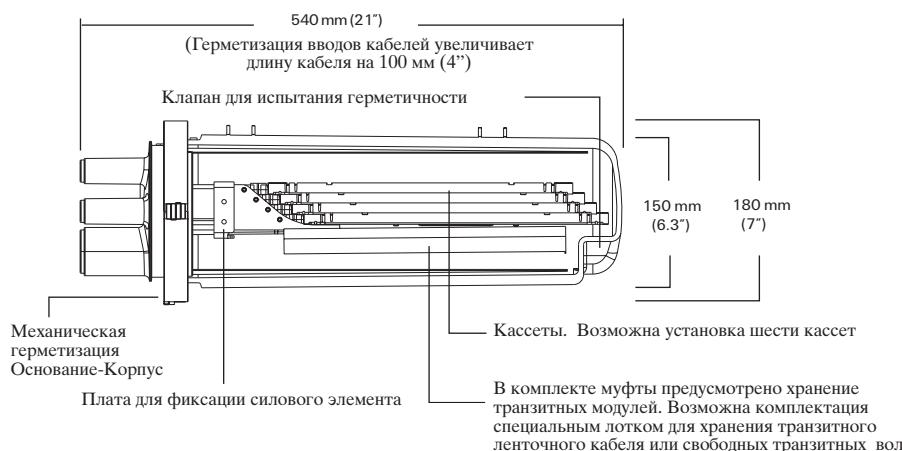
В комплекте муфты предусмотрено хранение транзитных модулей. Возможна комплектация специальным лотком для хранения транзитного ленточного кабеля или свободных транзитных волокон
