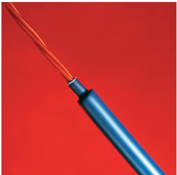
SCL - полужесткая термоусаживаемая трубка с клейкой внутренней стенкой, разработанная для обеспечения быстрой герметизации от проникновения влаги большой разновидности электрических деталей, включая сростки проводов, концы проводов и электронные компоненты. При охлаждении сплошная масса становится твердым, жестким, однородным покрытием с определенной толщиной стенки.
