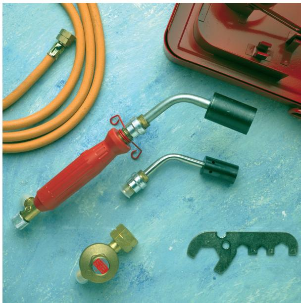
Газовые горелки Tyco Electronics имеют обычную рукоятку, которая может быть оснащена двумя форсунками. Каждая из форсунок имеет различного размера сопло: 30 мм сопло выдает большее пламя, чем сопло в 20 мм. Для соединения горелки с газовым баллоном, шланг на обеих сторонах оборудован закручивающимися переходниками.
