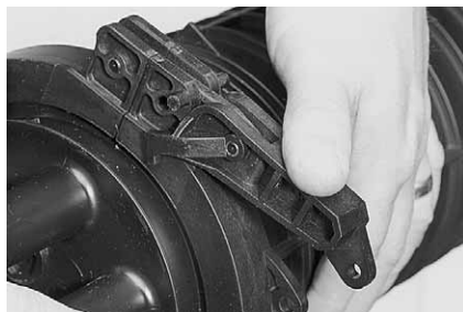
9.4 Осторожно наденьте корпус муфты поверх лотков на основание. Наденьте хомут на место стыка основания и корпуса муфты.
