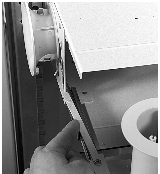
3.3.7 Вытяните корзину в полностью открытое положение и поверните две предохранительные скобы на 180° чтобы избежать возврата корзины внутрь панели.
