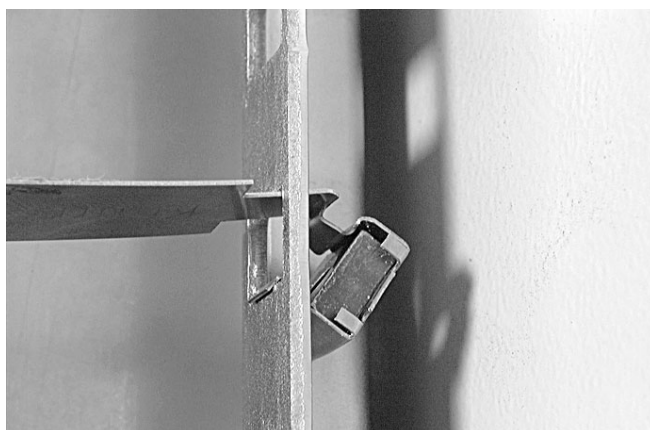
3.3.2 Определите положение панели (см. монтажную инструкцию стойки). Установите гайки в вертикальные направляющие стойки (используйте ключ FACС-CAGE-NUT-TOOL).
